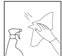
**ITA.** Pulire periodicamente gli apparecchi per rimuovere gli accumuli di sporco. Pulire le parti in acciaio utilizzando appositi detergenti. Per la pulizia dell'apparecchio utilizzare un panno morbido umido con sapone neutro.
