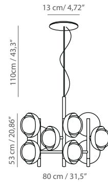
Togliere la corrente dalla rete. Effettuare il fissaggio della montatura dell'apparecchio con idonei tasselli e viti, controllando che i cavi di alimentazione uscenti non vengano deteriorati durante il montaggio. Montare secondo la sequenza indicata nel disegno. Pulizia - Pulire solo con panno inumidito con acqua. Smontare, lavare e rimontare i vetri solamente a interruttore spento
