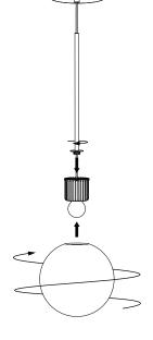
GLOBE THREADS ONTO LIGHT ENGINE
