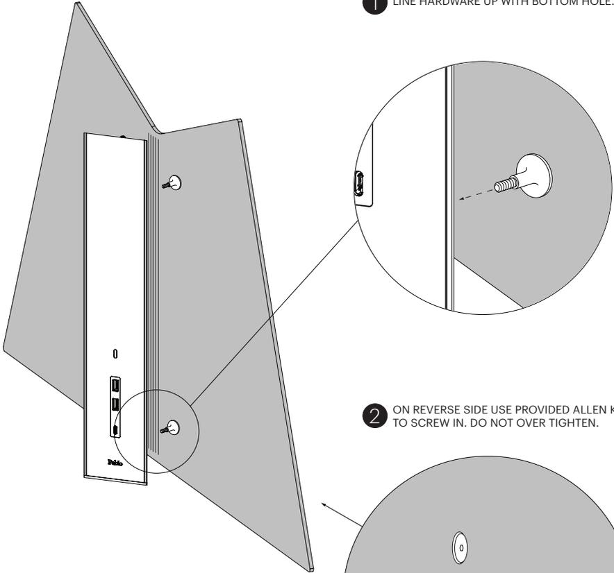
**2** ON REVERSE SIDE USE PROVIDED ALLEN KEY TO SCREW IN. DO NOT OVER TIGHTEN.
