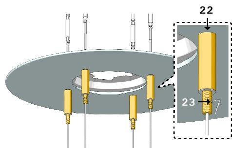
Una volta fissato il primo disco (21), proseguire con il montaggio dei dischi successivi (24, 25, 26, 27, 28, 29, 30, 31, 32). Fissare ciascun disco con quattro perni (22) e stringere su ogni perno il grano (23). Posizionare quindi l'ultimo disco (33).
