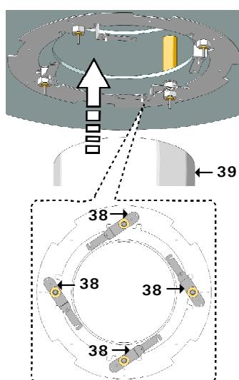
Posizionare le staffe (38) come indicato in figura in modo da permettere il passaggio del diffusore (39).
