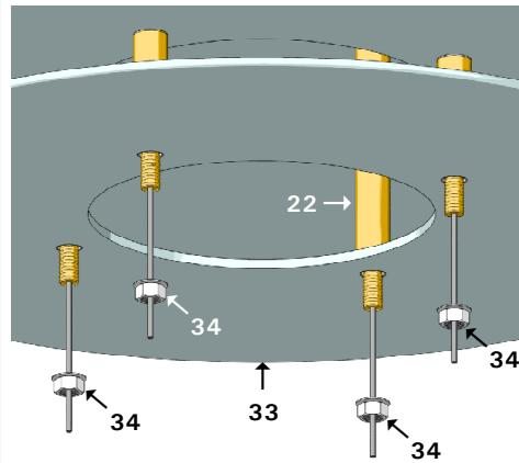
Fissare l'ultimo disco (33) all'estremità dei perni (22) tramite i quattro dadi (34) provvisti di rondella di protezione nella parte superiore.
