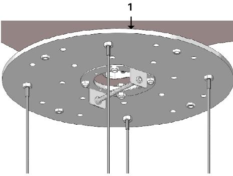
Portare la piastra (1) al soffitto. Tutti i fori liberi possono essere utilizzati per il fissaggio a soffitto tramite tasselli chimici in quantità e qualità adeguate al peso dell'apparecchio (circa 300 Kg nella versione in vetro e circa 200 Kg nella versione in metacrilato).
