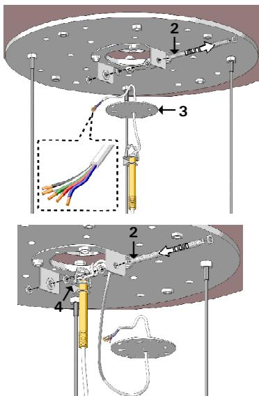
Rimuovere l'asta (2) svitando i rispettivi dadi e far passare i cavi di alimentazione provenienti dall'apparecchio attraverso il piattello (3). Riposizionare l'asta (2) facendola passare attraverso il gancio (4) ed eseguendo attorno ad essa un nodo con i cavi.
