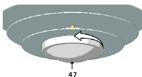
Ruotare il cappello inferiore (47) in modo da fissarlo all’anello di centraggio (35).
