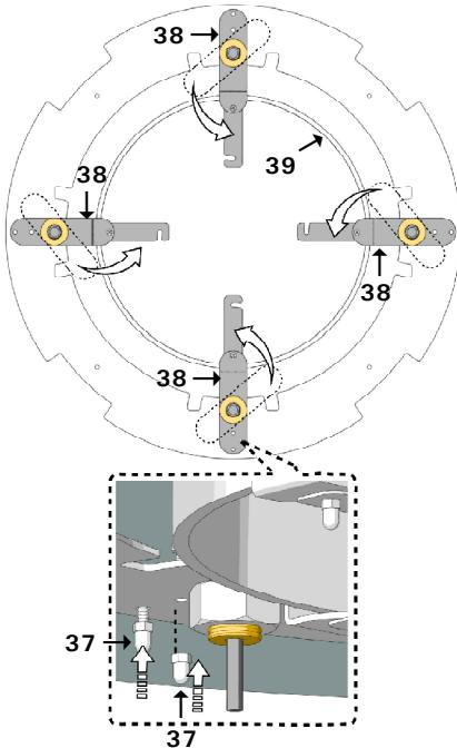
Una volta inserito il diffusore (39), riportare le staffe (38) nella posizione iniziale e fissarle nuovamente tramite una delle due viti (37).
