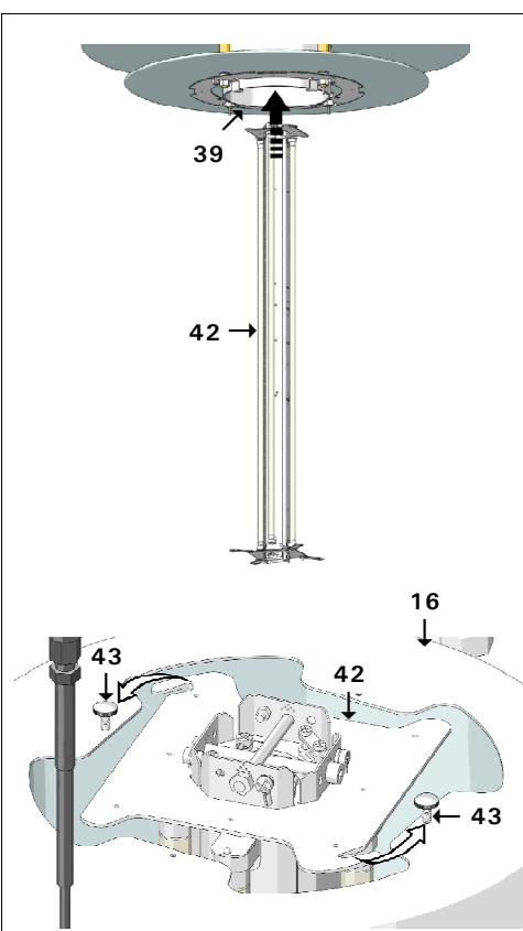
Inserire il gruppo portalampade (42) all'interno del diffusore (39) orientandolo rispetto al coperchio superiore (16) come indicato in figura. Avvitare le due viti (43) lasciate precedentemente lasche per fissare il gruppo portalampade (42) al coperchio superiore (16).
