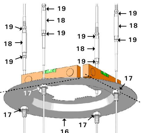
Fissare il coperchio superiore (16) con i quattro dadi (17) provvisti di rondella di protezione nella parte inferiore. Verificare il corretto bilanciamento del coperchio superiore (16) utilizzando una livella; se necessario, regolare l'altezza agendo sulle canaule (18). Una volta trovata la posizione corretta, serrare nuovamente i dadi (19).
