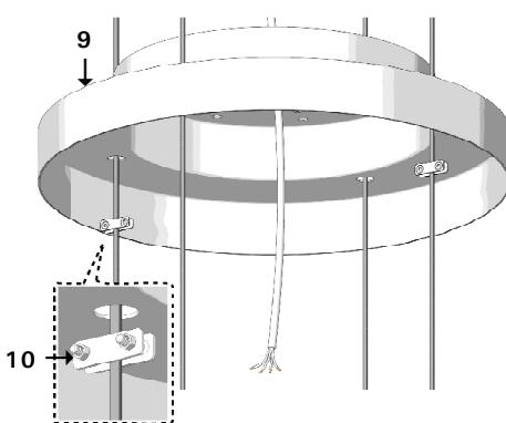
Inserire il cappello superiore (9) sui cavi di sospensione e fissarlo tramite i dispositivi di bloccaggio (10) su due dei quattro cavi. In tal modo il cappello superiore (9) viene mantenuto in posizione rialzata durante l'intera sequenza di montaggio.
