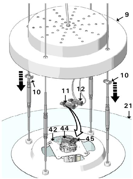
Effettuare i collegamenti elettrici tra i connettori (11) e (12) e i connettori (44) e (45) presenti sulla parte superiore del gruppo portalampade (42). È ora possibile svitare i dispositivi di bloccaggio (10) in modo da poter appoggiare il cappello superiore (9) al disco superiore (21).
