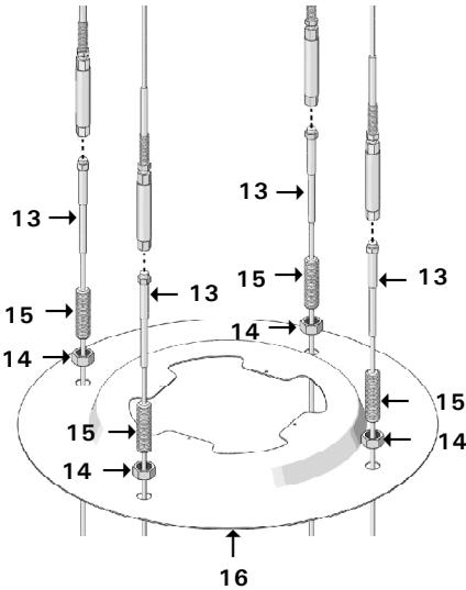
Fissare la seconda parte dei cavi di sospensione (13). Avvitare i dadi (14) sprovvisti di rondella di protezione fino all'estremità dei perni filettati (15) e posizionare il coperchio superiore (16).
