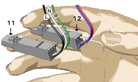
Inserire i cavi di alimentazione nei morsetti di collegamento (11) e (12) rispettando le polarità, ovvero: nel morsetto 3x (11), verde per il cavo di terra, bianco per il cavo neutro, nero per la linea; nel morsetto 2x (12), rosso e blu per l'eventuale collegamento al sistema DALI.
