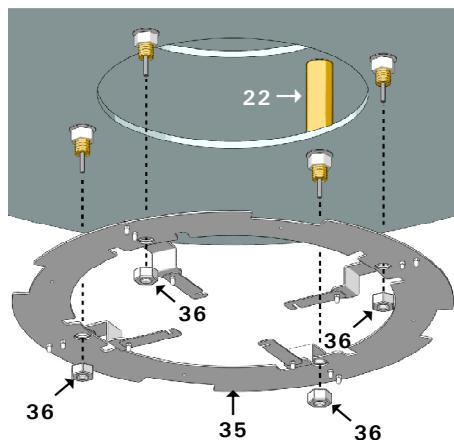
Calzare l'anello di centraggio (35) sulle estremità dei perni (22) e fissarlo tramite i dadi (36).
