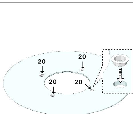
Nel caso di dischi in vetro (0024/3VN), posizionare in prossimità dei fori di fissaggio di ciascun disco le boccole (20).
